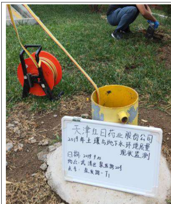
泉发路 S1 井水位测量
