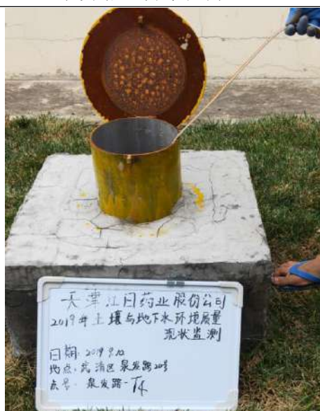
泉发路 S4 井水位测量
