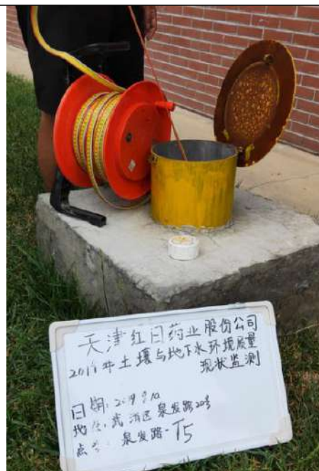
泉发路 S5 井水位测量
